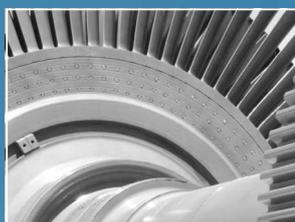
Se realizan balanceos con equipamiento portátil de alta resolución para rotores que giren entre 100 y 40.000 rpm, no importa su tamaño.
